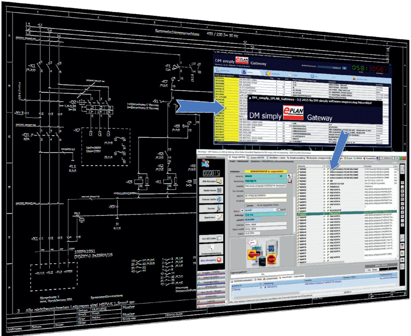
Alle Stammdaten und elektrische Zusatzinformationen werden aus der EPLAN-Datenbank extrahiert, aufbereitet und formatiert an das **DM simply PDM** übertragen.
